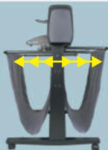
Lors de l'avance du matériel (vinyle ou autre) le matériel est recueilli dans un panier en toile ce qui empêche l'amasement de poussières et débris sur le vinyle. Ceci élimine le problème du vinyle contaminé par les impuretés présentes au sol abîmant l'état de surfacage ou pris au piège dans la couche de colle entre vinyle et support.
