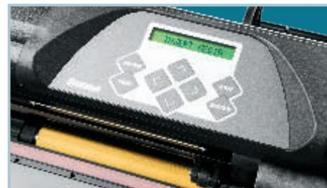
Le panneau de contrôle multilingue facilite le changement de réglages tels que vitesse et pression de coupe.
